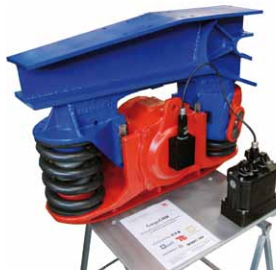
Modell der Datensammlung am Achslagerdeckel und Leitung der Daten in die Verarbeitungs- und Speicherbox
