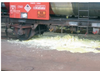
Undichte Armaturen: Sind die Werkstätten für solche und andere Fälle ausreichend versichert?
