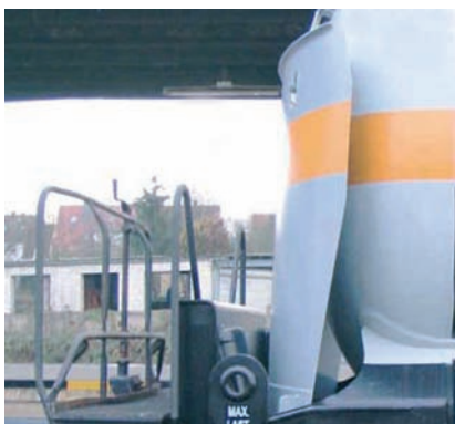
Schutzschild am Chlorwagen zum Schutz des Tanks.
