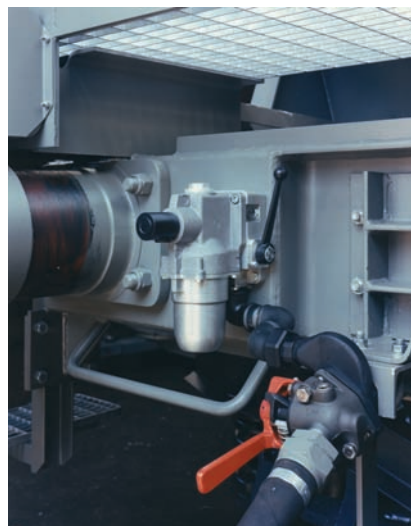
Entgleisungsdetektoren werden an jedem Wagene am Stossbalken angebaut und pneumatisch über eine 1"-Leitung mit der Hauptluftleitung des Zugs verbunden.
