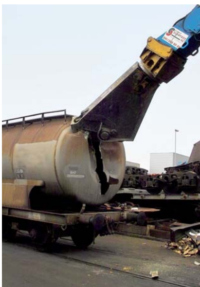
Schweres Gerät beim Verschrotten von Kesselwagen: Schrottschere im Einsatz.
