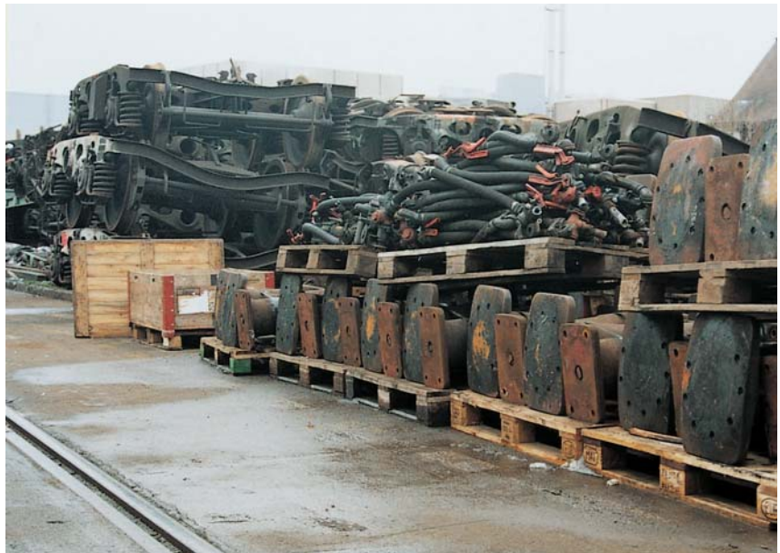
Umweltfreundlich: Noch funktionsfähige Puffer und Drehgestelle werden zur späteren Weiterverwertung aussortiert.
