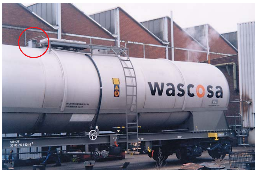
Telematiksystem – montiert an einem Kesselwagen der WASCOSA AG
